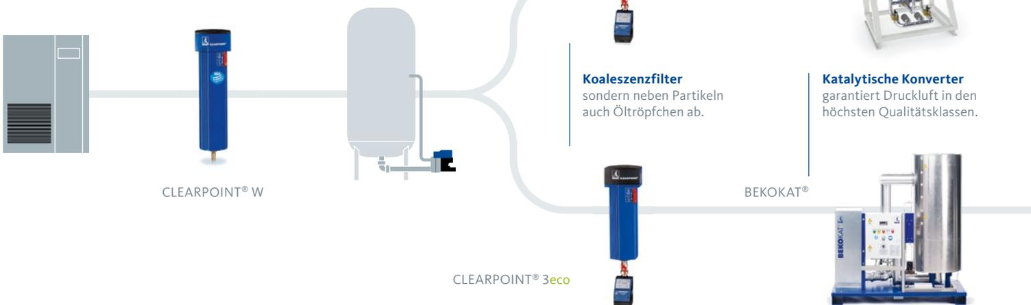
**Adsorptionstrockner** sorgen dafür, dass die Aufnahmekapazität der Aktivkohleabsorber nicht durch Wassermoleküle blockiert wird.
