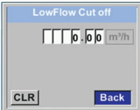
Die Schleichmengenunterdrückung kommt in Anwendung um Verbrauchswerte unterhalb des definierten „LowFlow Cut off“ Wertes als 0 m³/h anzuzeigen und auch nicht zum Verbrauchszählerstand zu addieren.
