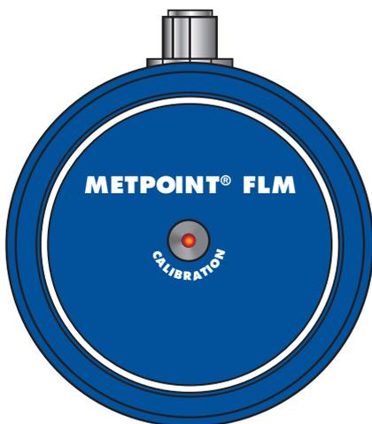
Auf der Oberseite des Gehäuses des METPOINT® FLM befindet sich eine LED zur Anzeige des Kalibrierzeitpunkts. Nach einer Zeit von 15 Monaten wird durch Blinken die anstehende Rekalibrierung angezeigt. Das Blinken der LED hat keinen Einfluss auf die Messwerte. Das Messsignal wird weiterhin ausgegeben.
