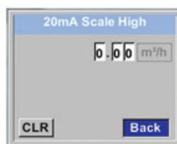
Hier wird die Skalierung für 4 mA und 20 mA des Stromausgangs festgelegt.
